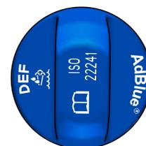
Le tuyau de remplissage du réservoir de fluide AdBlue® se trouve près du tuyau de remplissage de réservoir de carburant et son bouchon est bleu. Remplissez le réservoir à l'aide d'un bidon de fluide AdBlue®.
